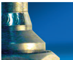
导管末端连接：激光焊
